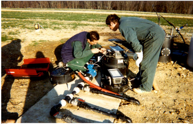
Traçage de lixiviats au chlorure de lithium (Montech, 1999) : Préleveur automatique en cours de réglage et vannes de distribution des lixiviats
