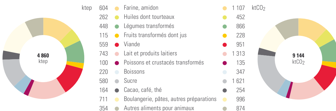
Figure 12. Empreinte énergétique et carbone de l'étape de transformation des produits consommés en France
