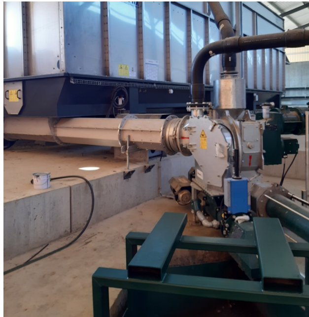
Figure 32 : Photo de broyeur à couteaux avec récupérateur de cailloux (SOLAGRO, 2021)
