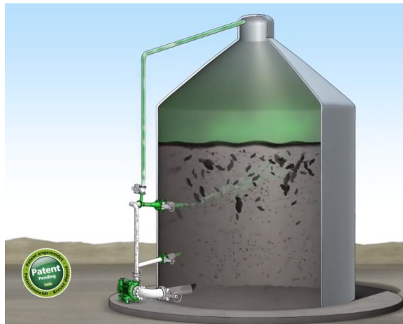
Figure 29 : Illustration du fonctionnement du procédé GasMix de Landia (Landia, 2014)
