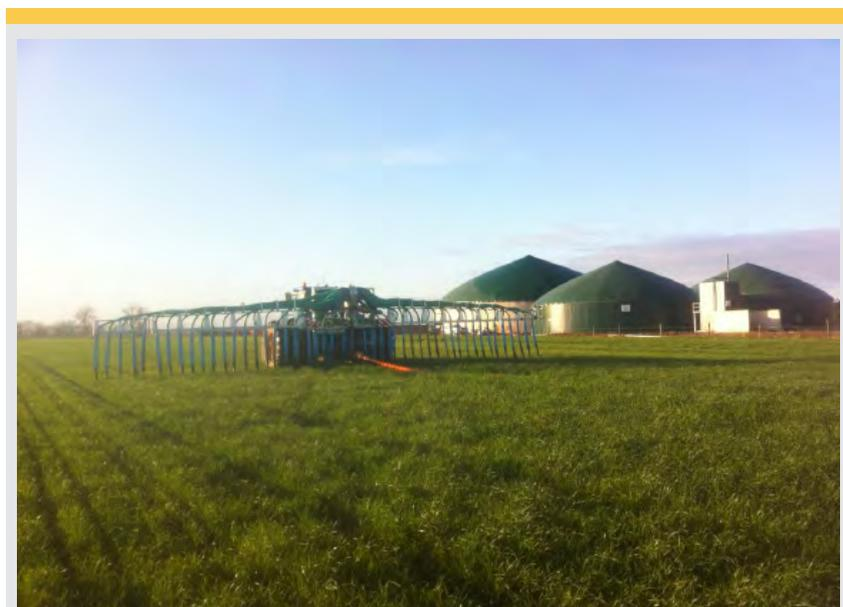
Épandage de digestat liquide avec pendillard pour limiter la volatilisation de l'azote
